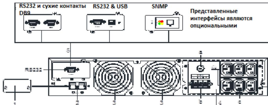
Рис 2-3 HR1102&HR1103 Передняя панель и два варианта задней панели.
