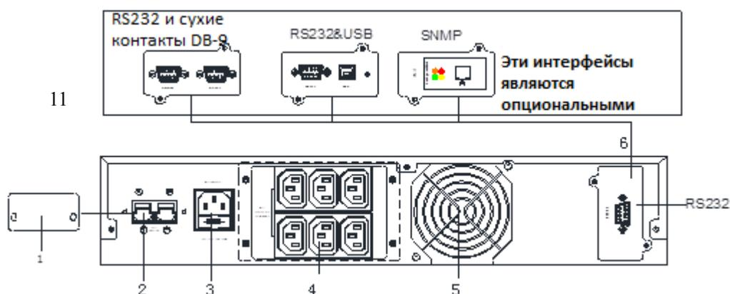
Рис. 2-2 Возможные конфигурации задней панели ИБП HR1101S (L)
