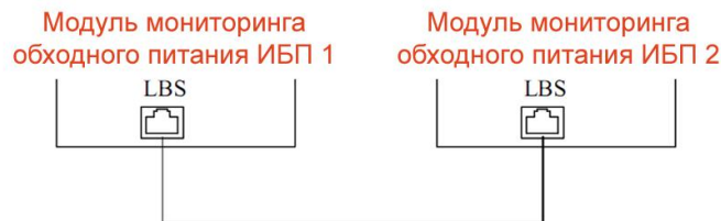
Рис. 1-20. Схема соединения LBS
