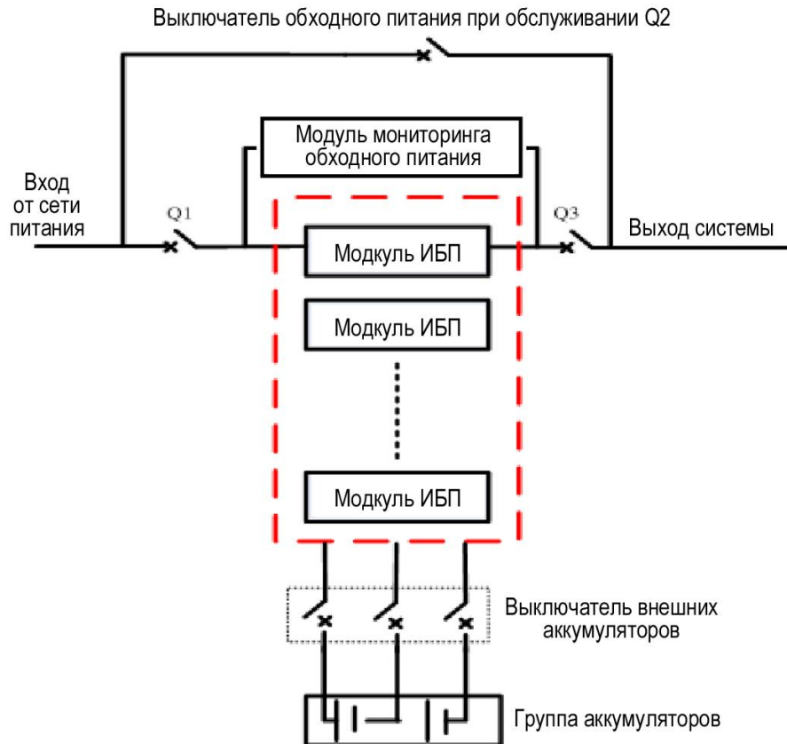
Рис. 2-1. Функциональная схема ИБП
